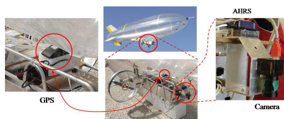
Figura 1: O dirigível tele-operado com o AHRS, câmera e GPS montados na sua gôndola.
