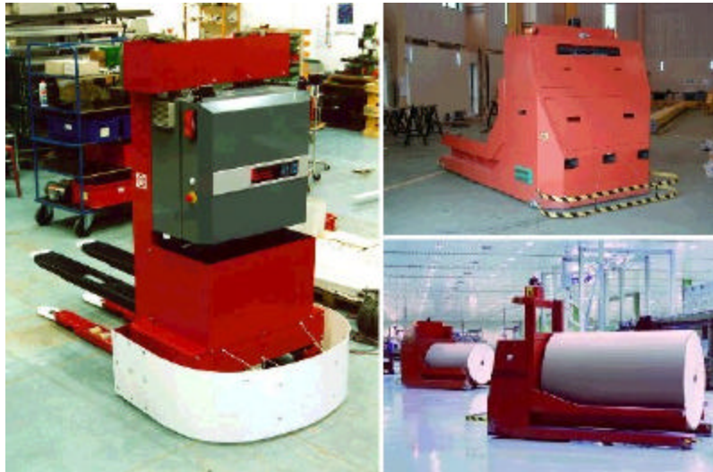
Figura 8 – AGV's equipados com garfos elevatórios (Soporcel, Soc. Portuguesa de Papel, S.A.).
