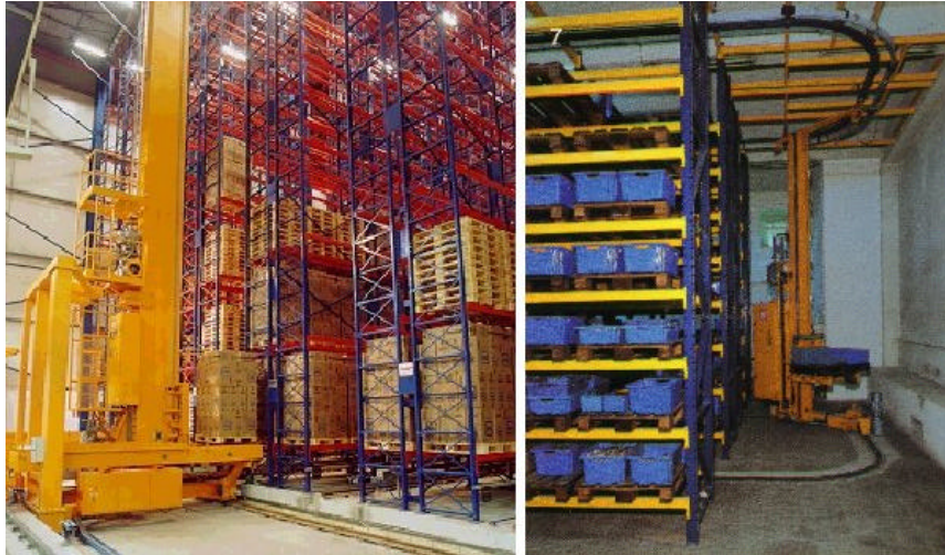
Figura 11 – Stacker-crane s com mudança de ala: à esquerda, através de um transfer car ; à direita, através de alas ligadas por curva.
