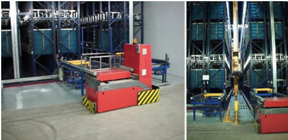
Figura 6 – AGV's equipados com um transportador por tapete (Bank of China, Hong-Kong Branch).
