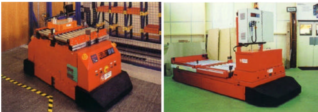
Figura 7 – AGV's equipados com 2 transportadores de rolos: à esquerda, AGV do CCP – Centro de CIM do Porto, carga máxima 200 Kg; à direita, AGV da YPF, S.A., Argentina, carga máxima 1250 Kg.
