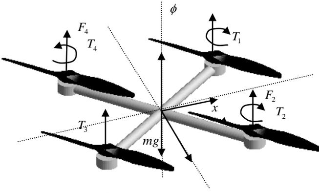
Fig. 8. Quad-Rotor model.
